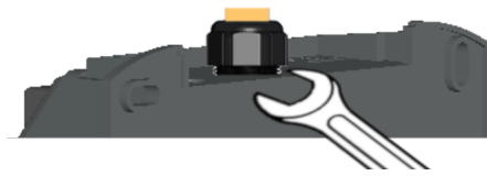
Fig. 6-15: Stram kabelforskrningen fra bagsiden
